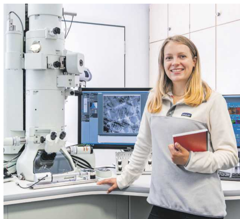
Larissa Heep charakterisiert im Rahmen ihrer Doktorarbeit am Durchstrahlungselektronenmikroskop die Struktur von Hochtemperaturwerkstoffen.
